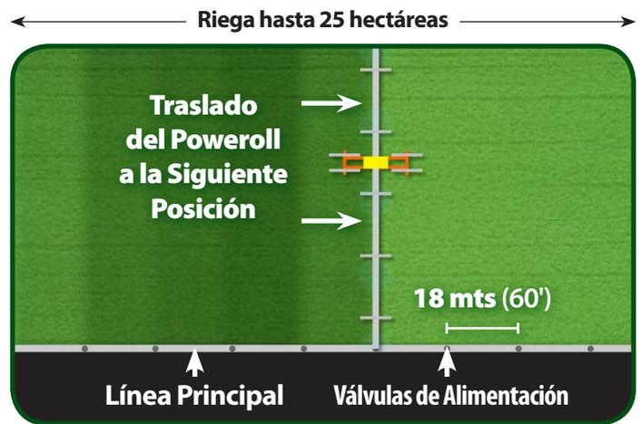
El Poweroll es una línea de aspersores hecho de aluminio montado sobre ruedas que riega en su lugar. En medio de la línea se encuentra el conjunto motor reductor de gasolina y transmisión hidrostática. La línea de aspersores se conecta al suministro de agua o a la línea principal por una manguera flexible.
